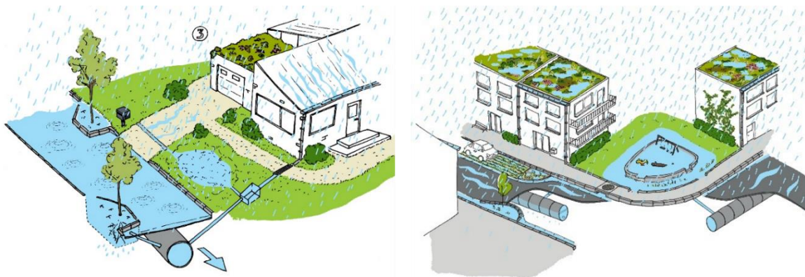
Figuur 15. Extreme neerslagafvoer: gecontroleerd overstroomen © Aquafin
